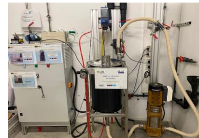
Réacteur tubulaire à ultrasons en mode batch avec circulation du milieu
